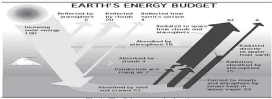
Fig. 1 : The Solar energy budget<sup>10</sup>
